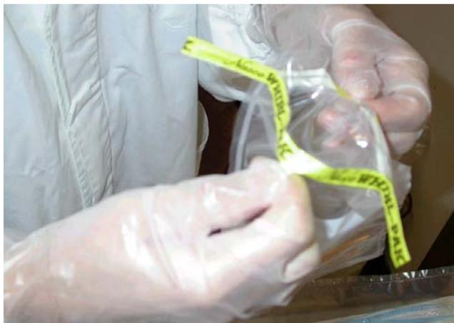
Figura 7. Strappare la linguetta che sigilla la busta contenente la spugnetta disidratata ed aprirla utilizzando le apposite linguette.
