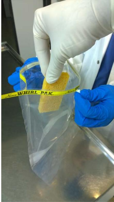
Figura 10. Con l'aiuto di un assistente al prelievo, che apre la busta utilizzando le apposite linguette laterali, afferrare con le dita la spugnetta indossando guanti sterili e avendo cura di non toccare superfici non sterili (vestiti, cute ecc.)
