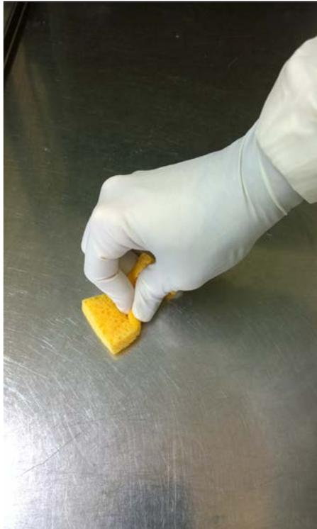
Figura 11. Strofinare la spugnetta sulla superficie da campionare, avendo cura di esercitare una pressione adeguata. E' necessario strofinare almeno 10 volte orizzontalmente e 10 volte verticalmente nell'ambito dell'area prescelta. Utilizzare tutta la superficie della spugnetta.
